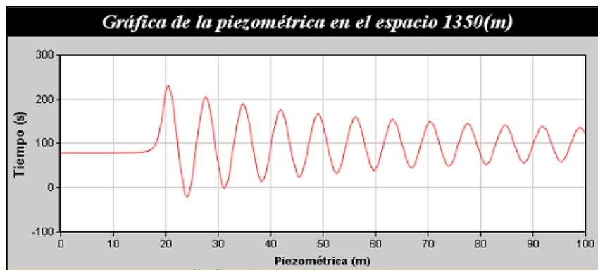
Figura A.I.22. Ventana de visualización de la evolución del transitorio en la longitud 1350 m
